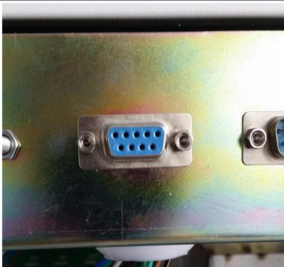
图 25 仪器端 COM 口（母）
