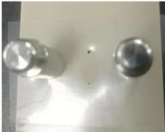
正确安装电极膜后，进出口处于露出状态
