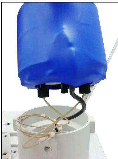
图 6-7 淋洗液发生罐管路连接
