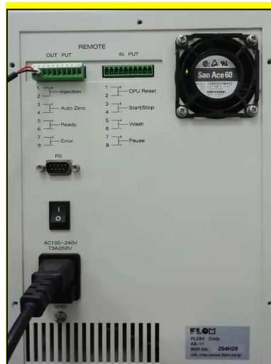
图 B-6 AS-11 后面板连接
