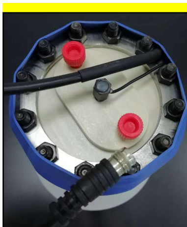
图 6-8 淋洗液发生罐堵头及电缆
