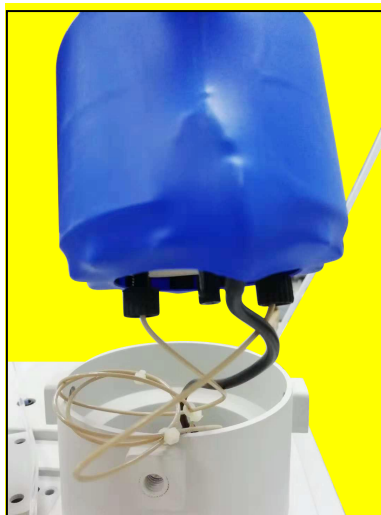
图 6-7 淋洗液发生罐管路连接
