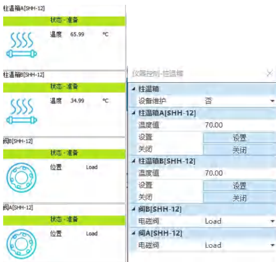
图 7-6 柱温箱控制界面
